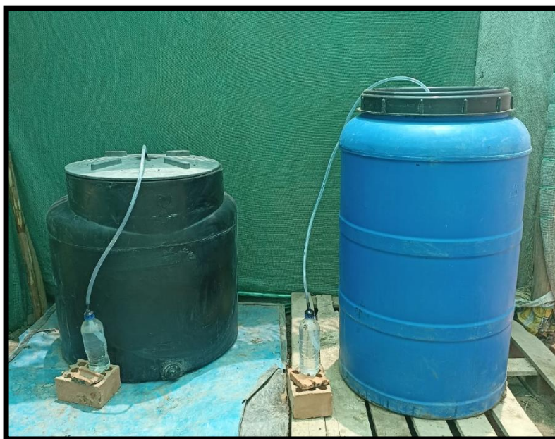
Figura 17. Biodigestores herméticamente sellados
